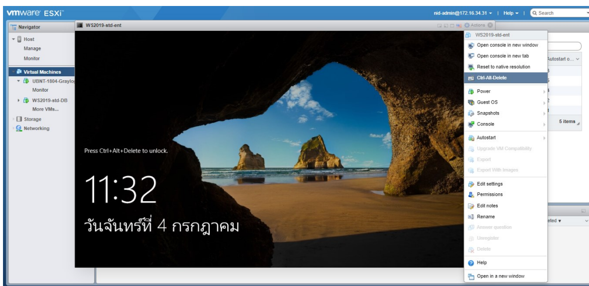
รูปที่ 5.9 เลือกไปที่เมนู Actions ด้านขวามือบน และเลือกเมนู Ctrl+Alt+Delete
